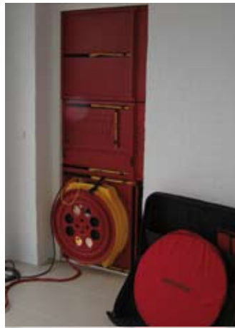
L'apparecchiatura del blower door in genere è installata nella porta di ingresso.
