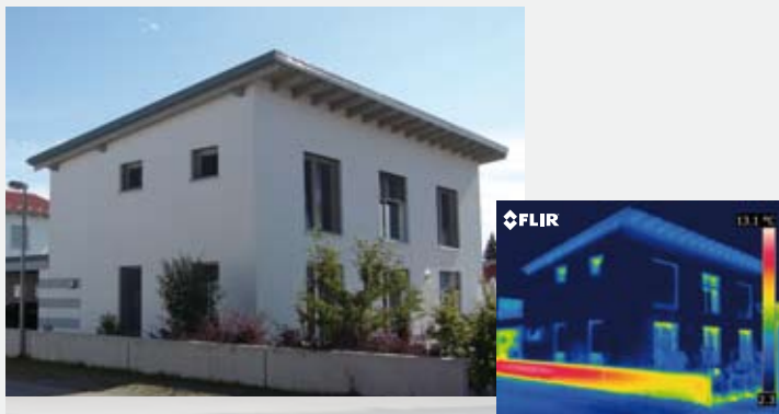
L'immagine ad infrarossi mostra la qualità dell'isolamento di una casa a basso consumo energetico
