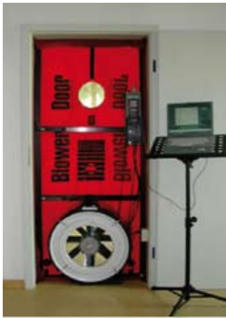
L'apparecchiatura del blower door in genere è installata nella porta di ingresso.
